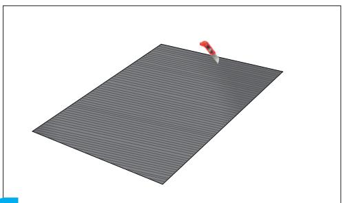
12 Meet het afvoerlichaam en knip het sloping board uit. / Mesurez le corps du drain et découpez la sloping board. / Messen Sie den Ablaufkörper und schneiden Sie das Sloping board aus. / Measure the drain body and cut out the sloping board.
