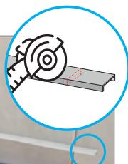
**Inkorten:** het rooster is eenvoudig in te korten met het meegeleverd doorslijpschijfje. / **Raccourcissement:** la grille peut être facilement raccourcie avec le disque de coupe inclus. / **Kürzen:** Mit der mitgelieferten Trennscheibe lässt sich das Gitter ganz einfach kürzen. / **Shorten:** the grating is easy to shorten with the supplied cutting disc.
