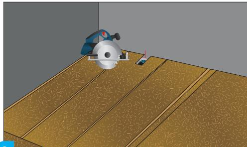
9 Snijd de opening in de vloerplaat. / Découpez l'ouverture dans le plancher. / Schneiden Sie die Öffnung in die Diele. / Cut the opening in the floorboard.
