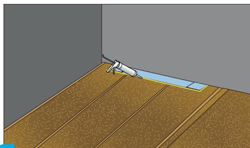
11 Werk de randen af met silicone om te voorkomen dat er vloeistof doorheen loopt. / Finir les bords avec du silicone pour empêcher le liquide de s'écouler. / Beenden Sie die Kanten mit Silikon, um zu verhindern, dass Flüssigkeit durchläuft. / Finish the edges with sealant to prevent liquid from running through.
