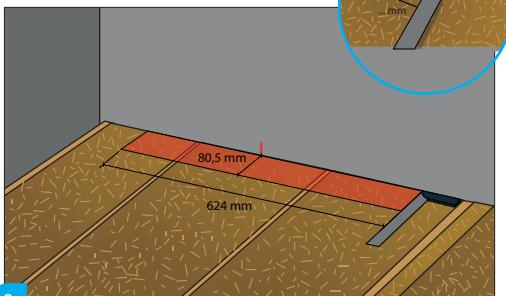
8 Gebruik de vooraf aangebrachte markeringen om op de vloerplaat de opening voor het afvoerlichaam aan te duiden. / Utilisez les marques pré-appliquées pour marquer l'ouverture du corps du drain sur la plaque de sol. / Verwenden Sie die vorgefertigten Markierungen, um die Öffnung für das Ablaufgehäuse auf der Bodenplatte zu markieren. / Use the pre-applied markings to draw on the floorboard where the opening for the drain body should be located.
