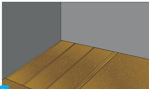
7 Plaats het triplex in en uit de natte ruimte. / Placez le contreplaqué dans et hors de la zone humide. / Legen Sie das Sperrholz in und aus dem Nassraumbereich. / Place the plywood in and out the wetroom area.
