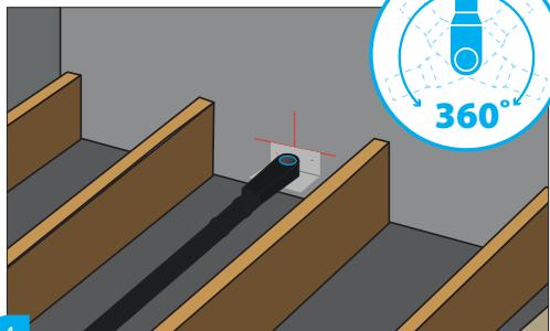
4 Schuifmof en buis aansluiten. / Connectez le manchon coulissant et le tuyau de vidange. / Schiebemuffe und Ablaufrohr anschließen. / Connecting waste connector and tube.
