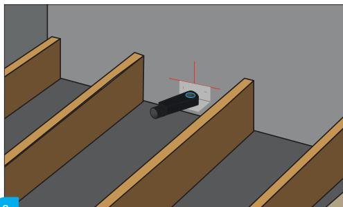
3 Lijn de sifon uit met de beugel. Draai de sifon in de juiste positie. / Alignez le siphon avec le support. Tournez le siphon dans la bonne position. / Richten Sie den Siphon mit der Halterung aus. Drehen Sie den Siphon in die richtige Position. / Align the siphon with the bracket. Turn the siphon into the correct position.
